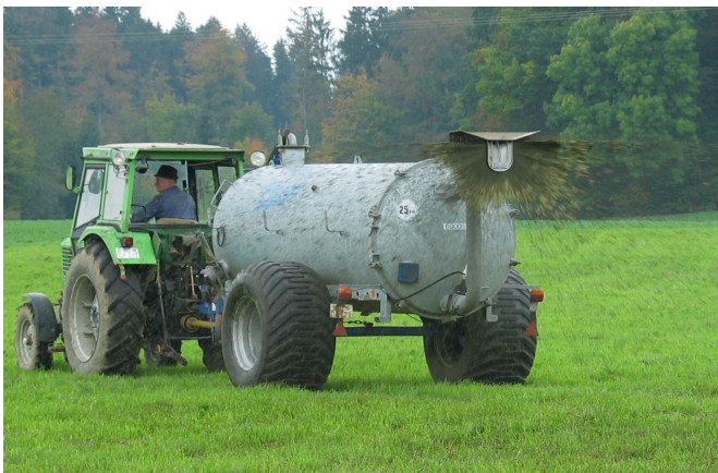
Foto 3: Prallkopfverteiler (ab 2025 nicht mehr zulässig)
