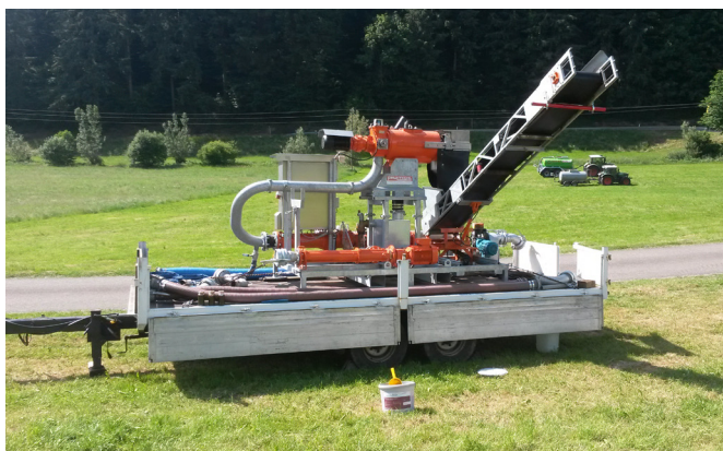
Foto 9: Gülleseparierer für den mobilen Einsatz
