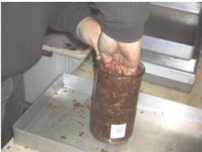
„Einstampfen“ von Apfeltrester in Einmachgläser für die Laborversuche.
