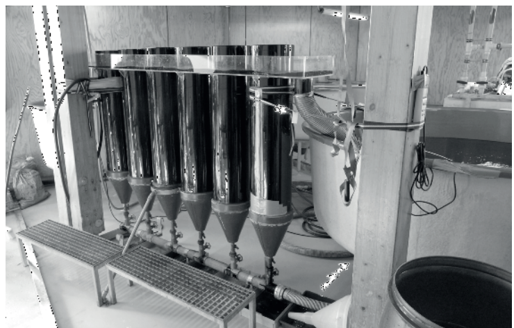
Abbildung 1: Die Markierungsanlage mit Zugergläsern zum Einfärben der Eier und Rundbecken zum Vorhalten der Markierungslösung.
